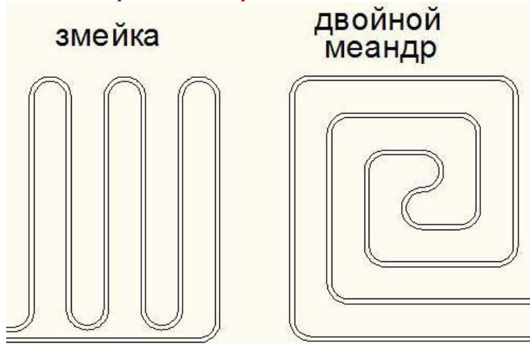
Рис.5.3.1.4. р.1 Способы раскладки петель теплого пола
