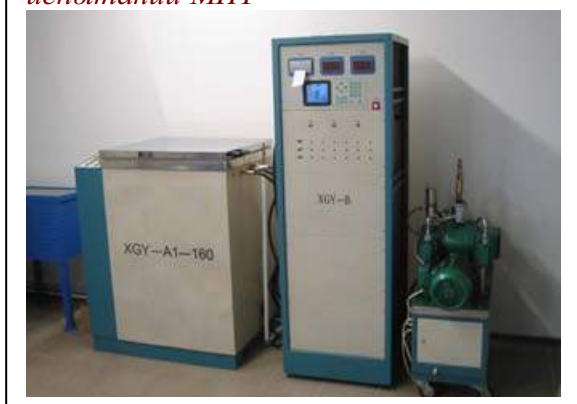
Рис.2.4.3.р.3 Стенд статических испытаний МПТ
