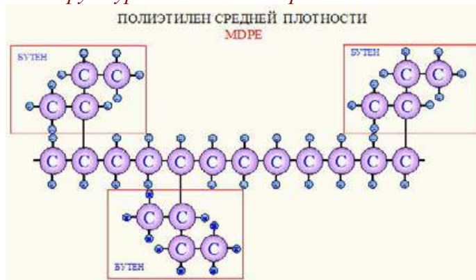
Рис. 2.1.р.4 Химическая структура полиэтилена средней плотности
