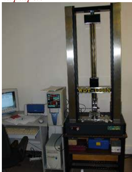
Рис.2.4.3.р.6 Стенд испытаний на разрыв
