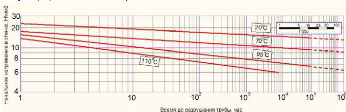
Рис.2.5.6.р.3 Графики длительной прочности МПТ Valtec
