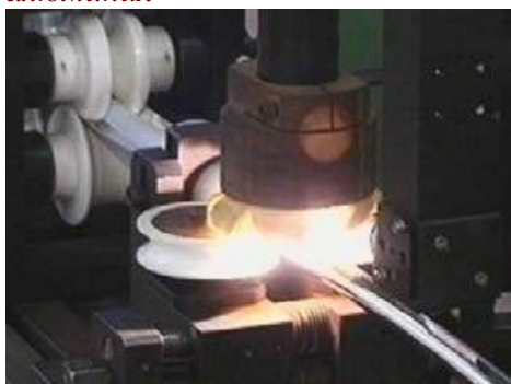
Рис.2.4.2.р.1 TIG сварка алюминия
