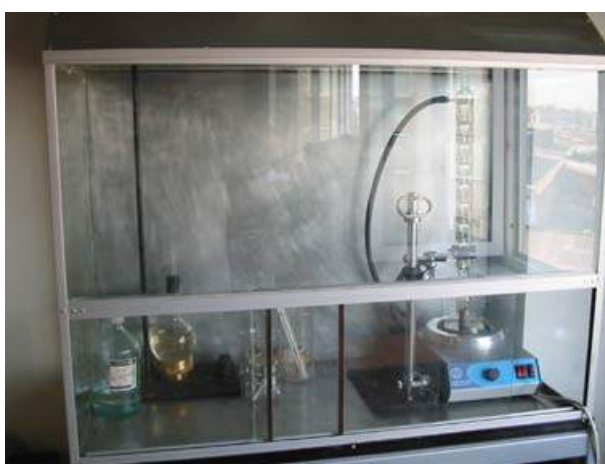
Рис.2.2.р.1 Стенд определения степени сшивки
