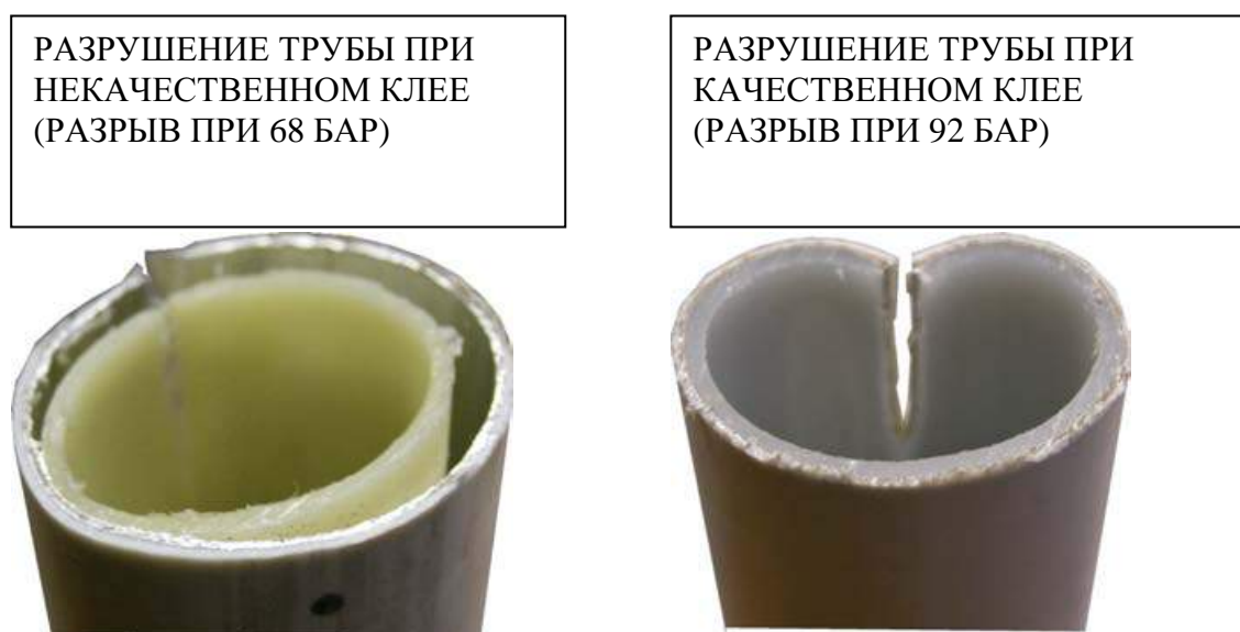
Рис.2.3.4.р.1 Вид среза МПТ после разрывных испытаний
