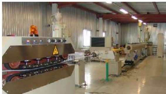
Рис.2.4.1.р.1 Линия по производству МПТ Valtec
